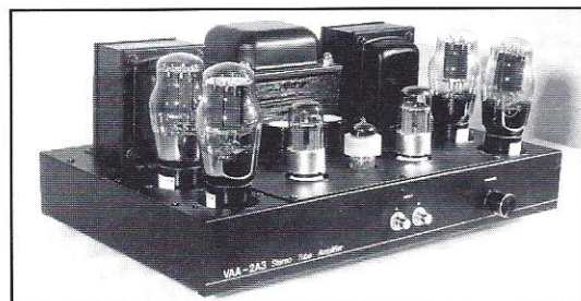
Bouwkit VAA-2A3 , 2A3 triodes in balans schakeling. 2 x 12 W. Prachtig midden/hoog 1495,-
